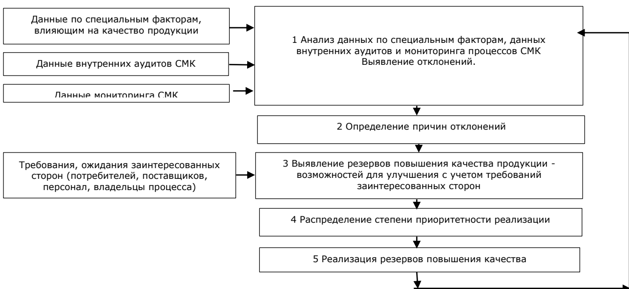
Рисунок 2 – Блок-схема формирования резервов повышения качества продукции на основе анализа специальных факторов, влияющих на качество продукции
