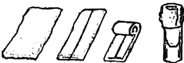
**Рисунок 54.** Приготовление ватной пробки
