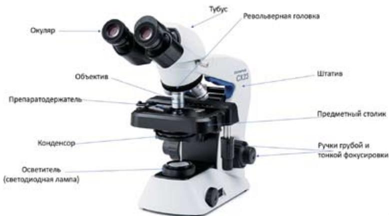
**Рисунок 2.** Основные части бинокулярного светового микроскопа [URL: <https://planetarium.ru/product/mikroskop-mikromed-stereo-ms-5-zoom-led/> (дата обращения: 07.06.2024)].
