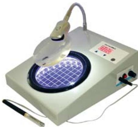
**Рисунок 38.** Счетчик колоний микроорганизмов
