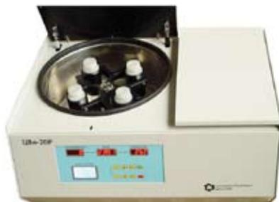
**Рисунок 17.** Скоростная рефрижераторная центрифуга
