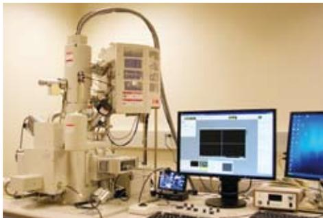
**Рисунок 6.** Электронный микроскоп
