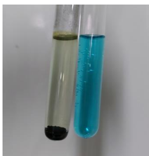
Рисунок 4. Фотографии пробирок, показывающие каталитическую активность феррита меди в реакции окисления метиленового синего пероксидом водорода
