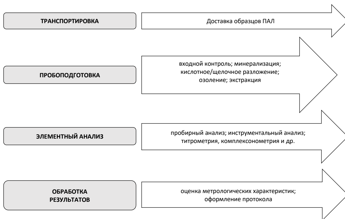
Рисунок 3. Схема процесса анализа полиметаллических руд в ПАЛ
