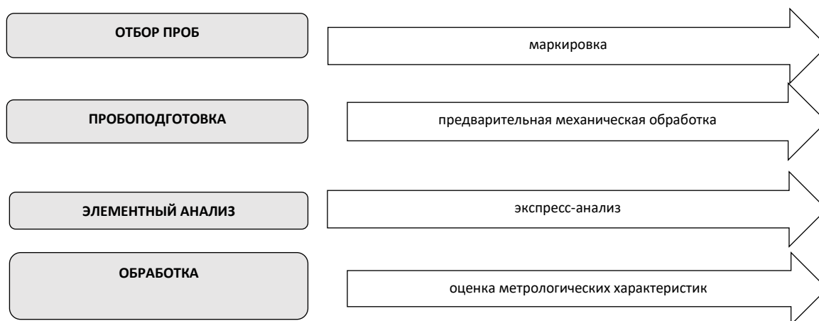
Рисунок 2. Схема анализа полиметаллических руд в экспресс-лаборатории
