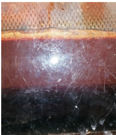
Фото 7. Расслоение раствора через 2 часа электролиза
