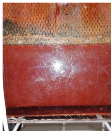
Фото 10. Расслоение раствора через 5 часов электролиза
