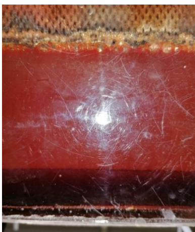
Фото 9. Расслоение раствора через 4 часа электролиза
