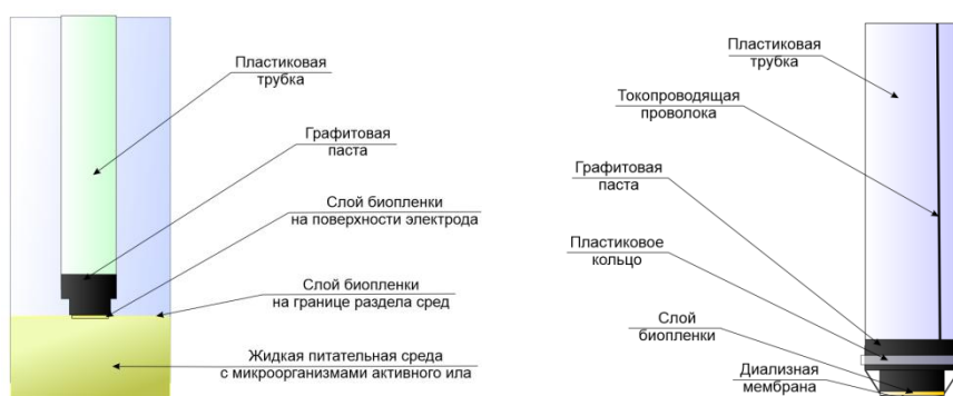
Рисунок 1. А - процесс нанесения биопленки микроорганизмов на поверхность электрода.
