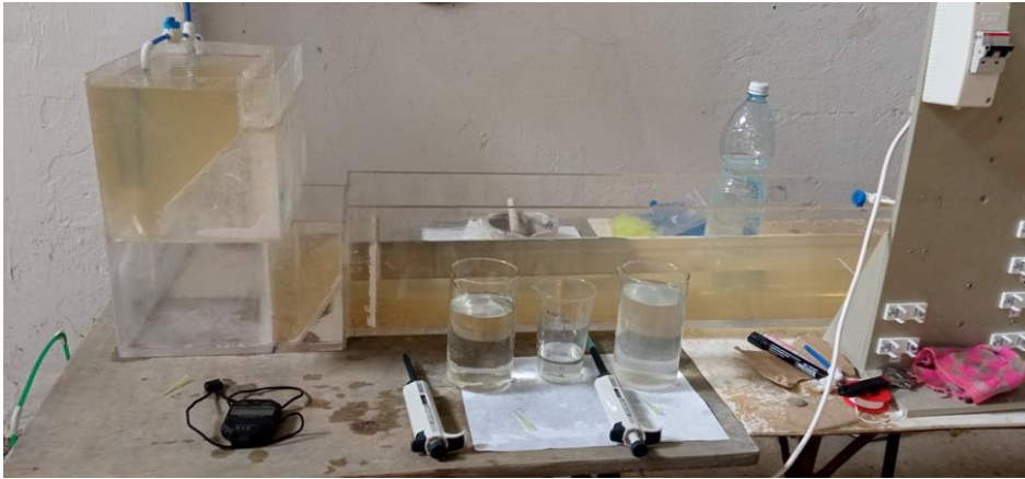
Рисунок 2. Макетная установка технологии очистки воды
