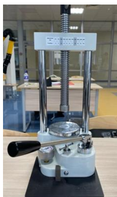
Рисунок 2. Гидравлический ручной пресс для формовки образца.
