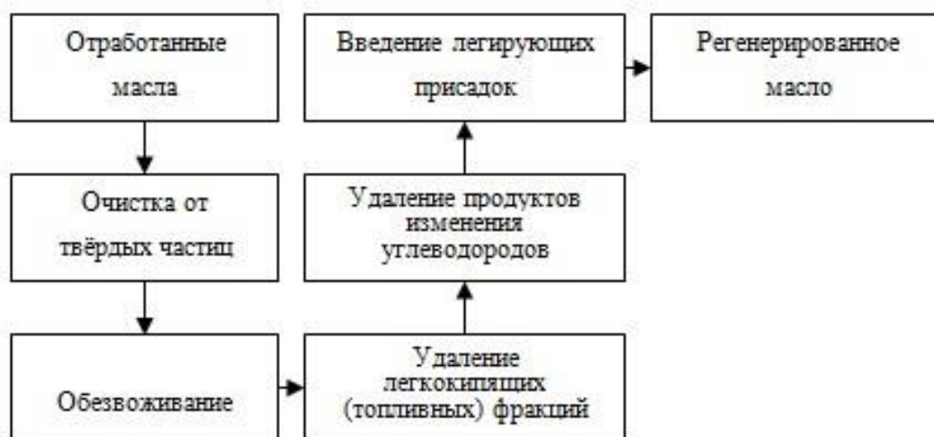
Рисунок 1. Стадии процесса регенерации отработанных технических масел
