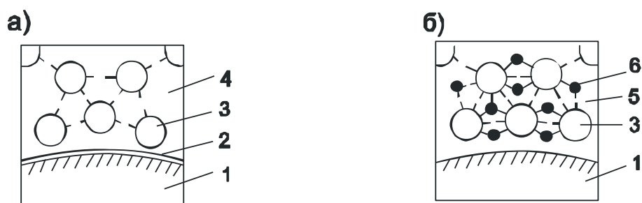
а – без разжижителя; б – с формиатно-спиртовым разжижителем; 1 – заполнитель; 2 – пылевато-глинистая плёнка на поверхности заполнителя; 3 – зёрна цемента; 4 – вода; 5 – смесь воды и разжижителя; 6 – зёрна пылевато-глинистой составляющей
