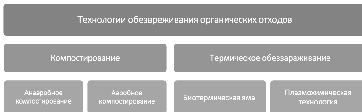
Рисунок 5. Основные технологии обезвреживания органических отходов [4]
