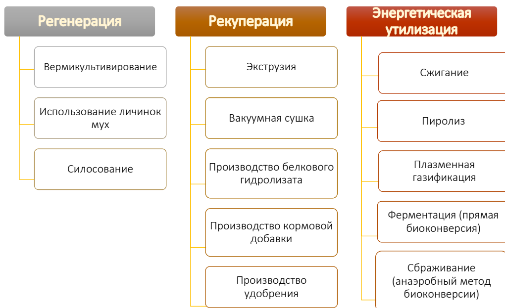
Рисунок 4. Основные технологии регенерации, рекуперации и энергетической утилизации органических отходов [5, 6, 8]
