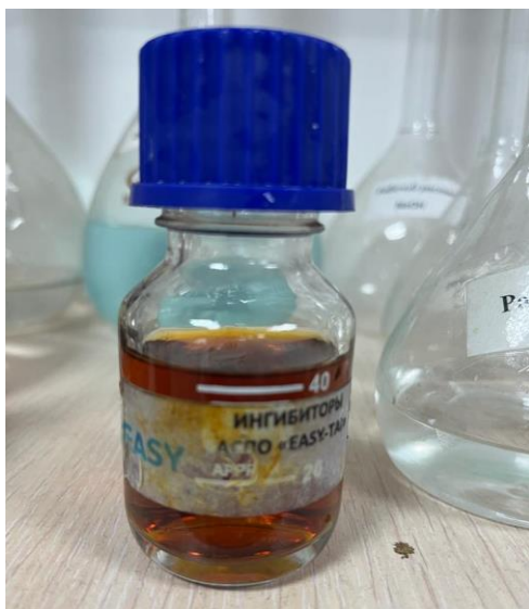
Рисунок 10. Пробы модели нефти с добавлением EASY-TAI. Муть, связанная с охлаждением. Жидкость не потеряла своей текучести, однородна
