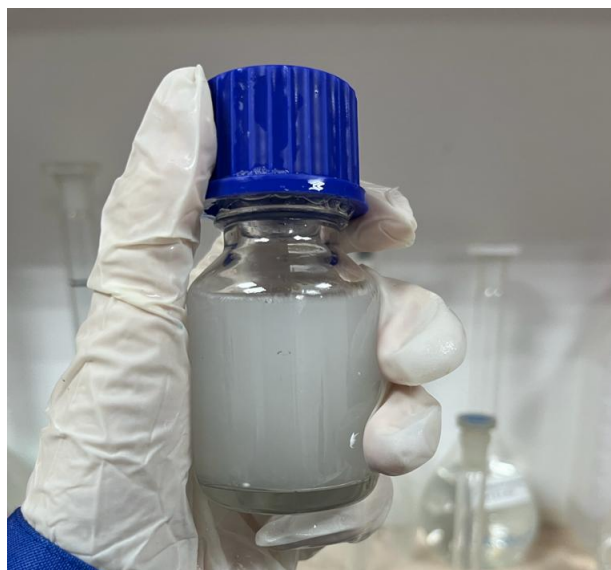
Рисунок 11. Пробы модели нефти без добавления EASY-TAI. Муть, связанная с охлаждением. Жидкость слабоподвижная, вязкая, образовалась граница раздела двух сред
