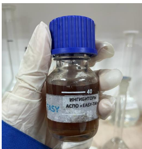
Рисунок 4. Пробы модели нефти с добавлением EASY-TAI. Полное растворение парафинов
