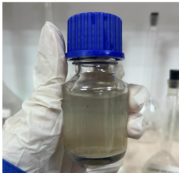
Рисунок 13. Пробы модели нефти без добавления EASY-TAI. Образование границы раздела двух сред, парафин выпал в осадок
